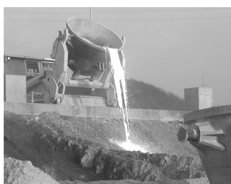
製鋼スラグの徐冷過程
